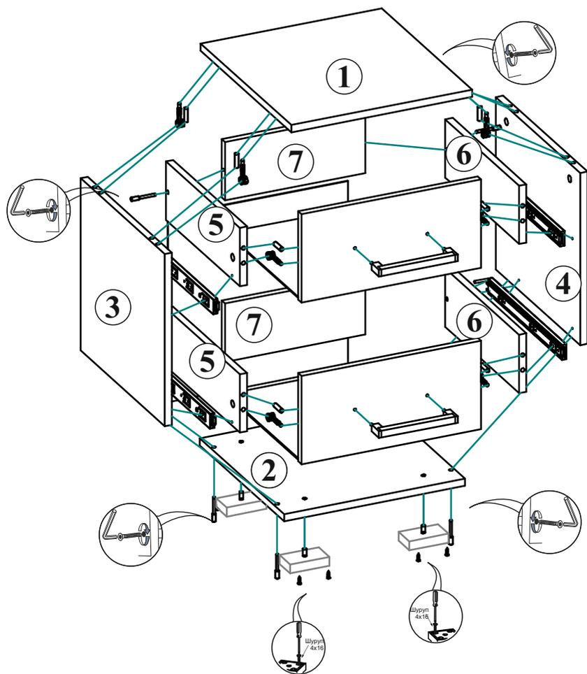
схема монтажа эксцентриковой стяжки
